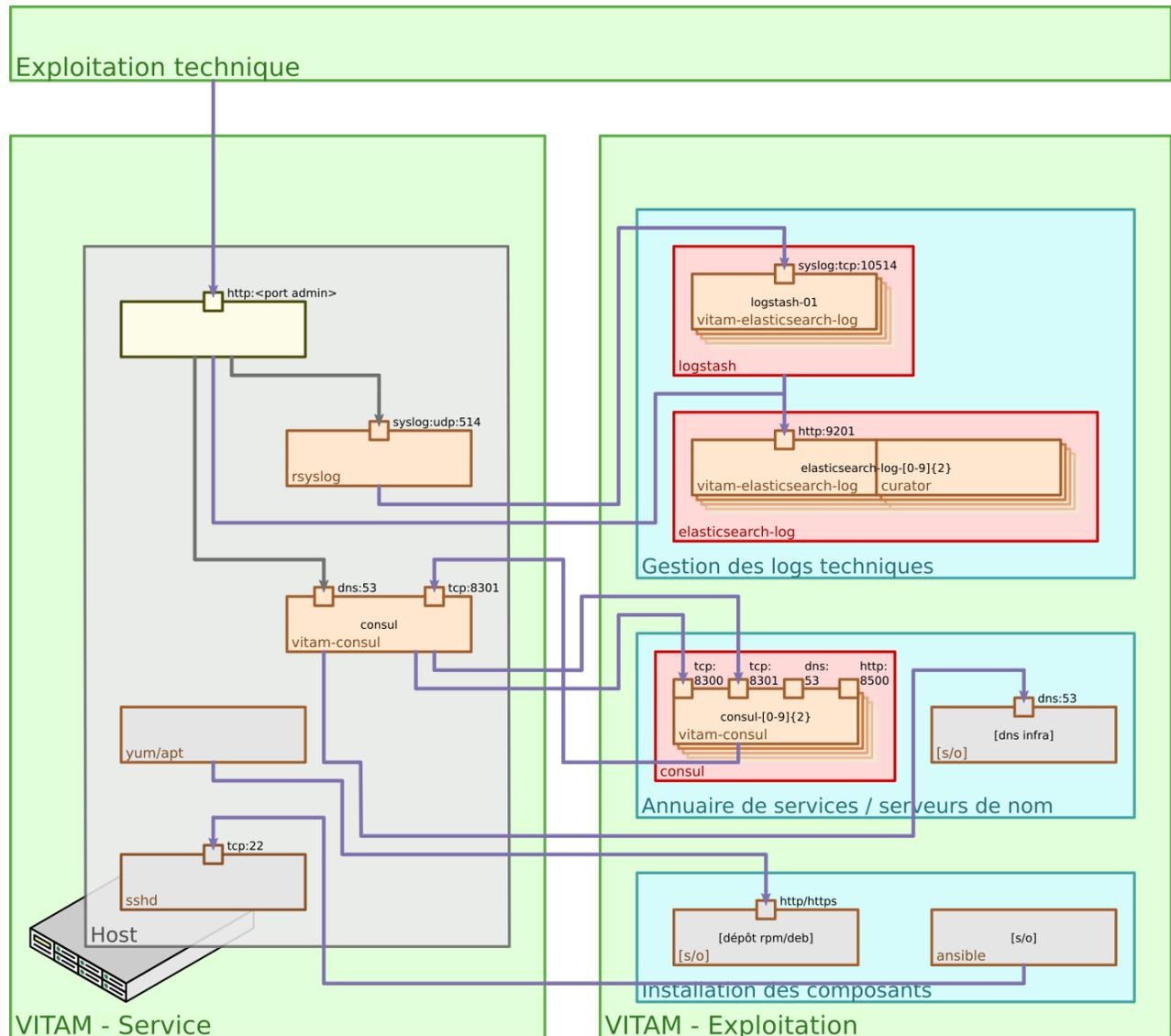
Fig. 5.10 – Architecture du sous-système de centralisation des logs
