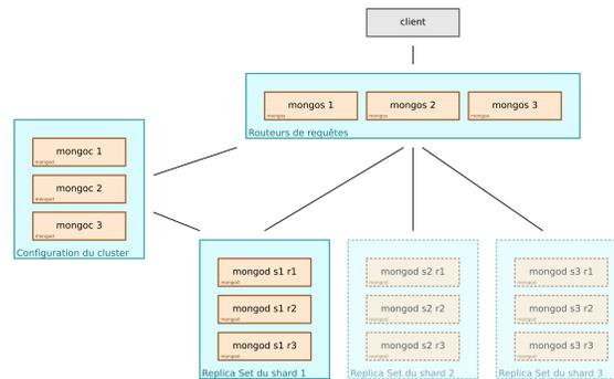
Fig. 5.11 – Déploiement d'un cluster Mongo DB avec sharding.
