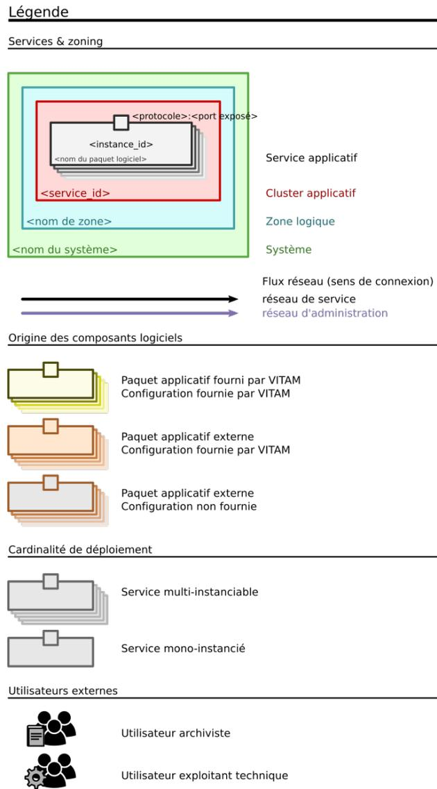
Fig. 5.3 – Architecture technique : légende
