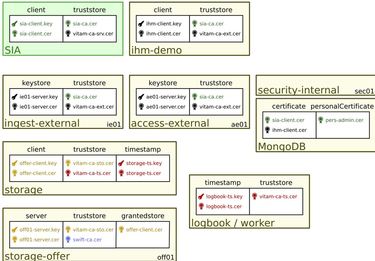
Fig. 6.1 – Vue d'ensemble des magasins de certificats déployés dans un système VITAM ; chaque couleur correspond à une chaîne de certification potentiellement disjointe des autres.
