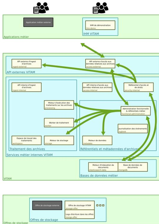
Fig. 4.4 – Architecture applicative : flux de données de référentiels
