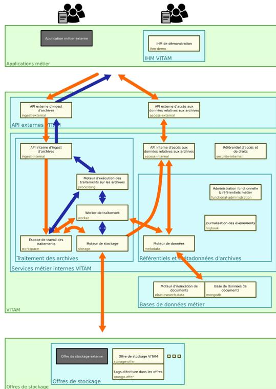
Fig. 4.2 – Architecture applicative : flux de données d'archives et de commandes
