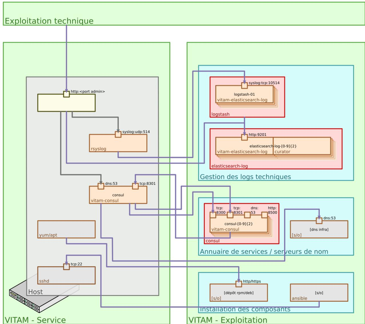
Fig. 5.8 – Architecture technique : flux (5/5 : flux du socle technique). Seul le port exposant les services d’administration/exploitation est représenté sur le composant VITAM présenté dans cette figure.
