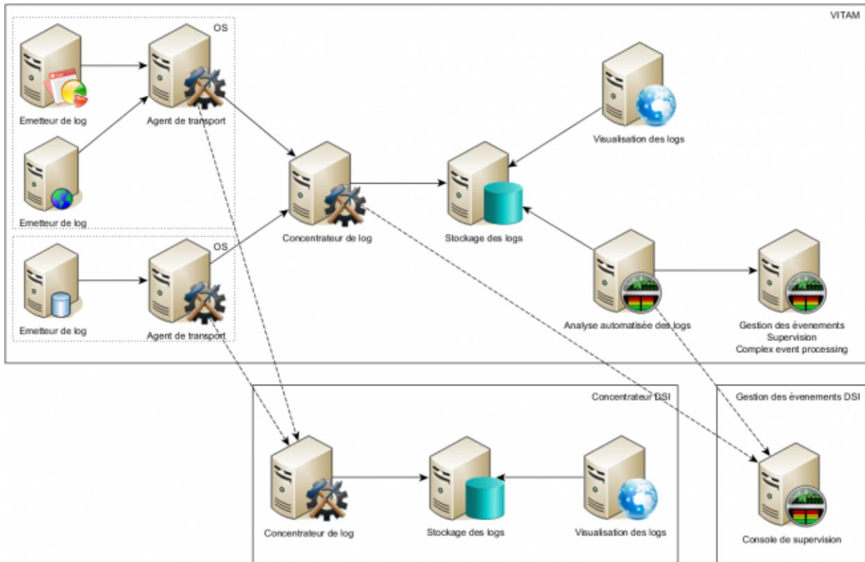
Fig. 5.9 – Architecture générique d'un système de gestion de logs.
